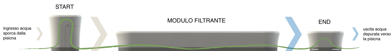
Fig.20 Schema del percorso del flusso d’acqua nel sistema
