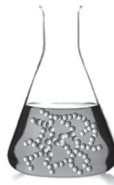
7. GEL: reticolo di una certa rigidezza, in cui rimane intrappolato il solvente 9
