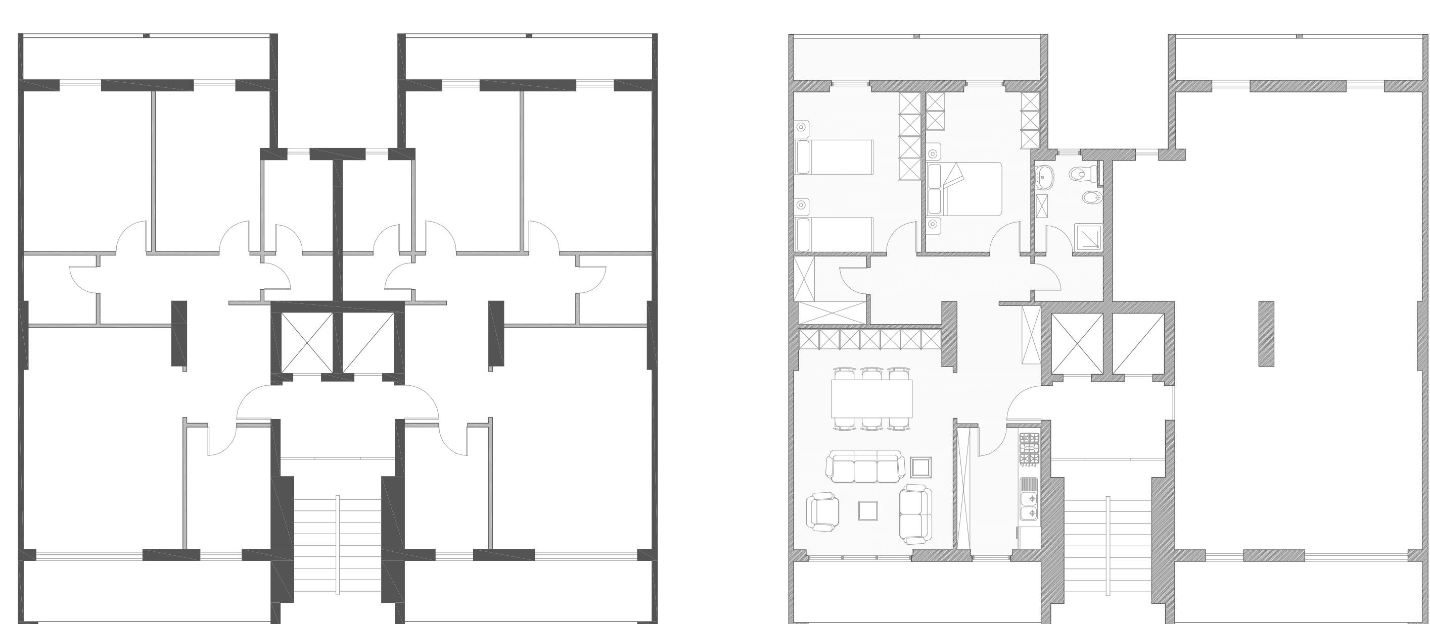
DEMOLIZIONE TRAMEZZI INTERNI IN CARTONGESSO
