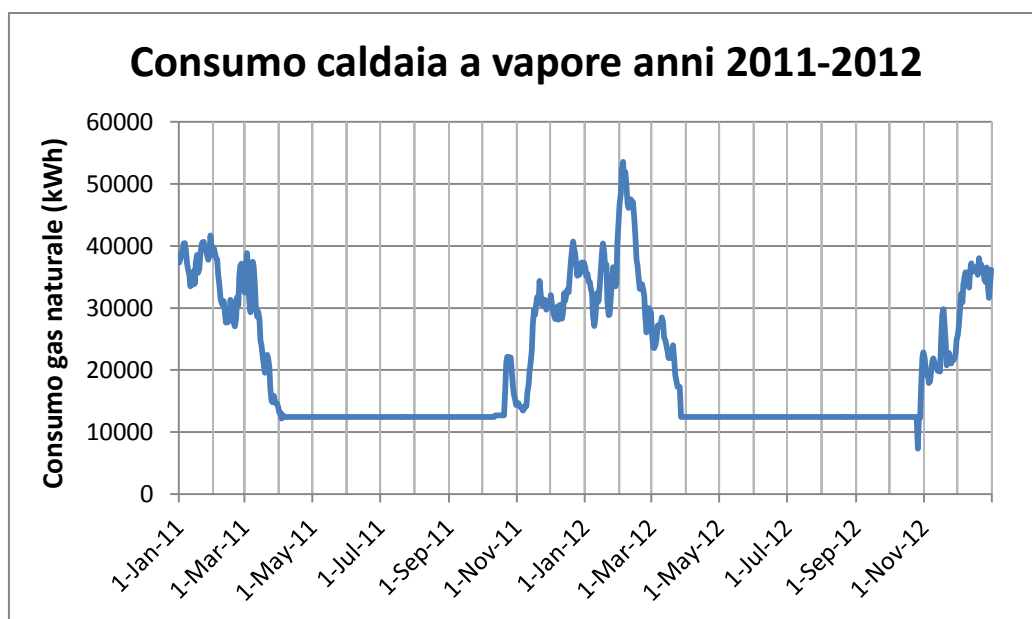
Figura 3.6. Consumi di gas naturale della caldaia per la produzione di vapore, in kWh consumati in 1 giorno (24h) per ogni giorno degli anni 2011 e 2012.
