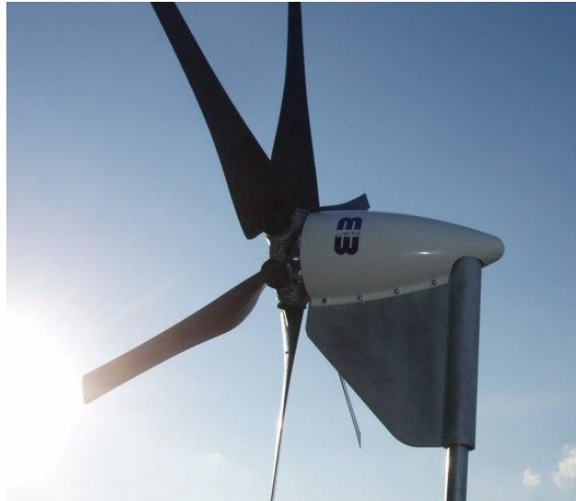
Figura 4 - Esempio di turbina downwind
