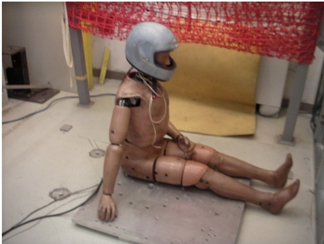
Figura 4.3: Piastra d'acciaio su cui viene appoggiato il manichino
