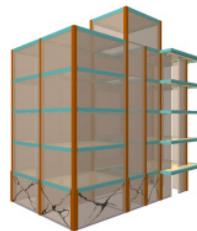
DANNI A PIANO TERRA
