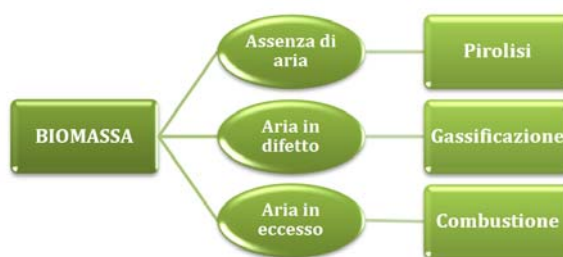
Figura 3.5 - Classificazione dei processi di conversione in base all'agente ossidante
