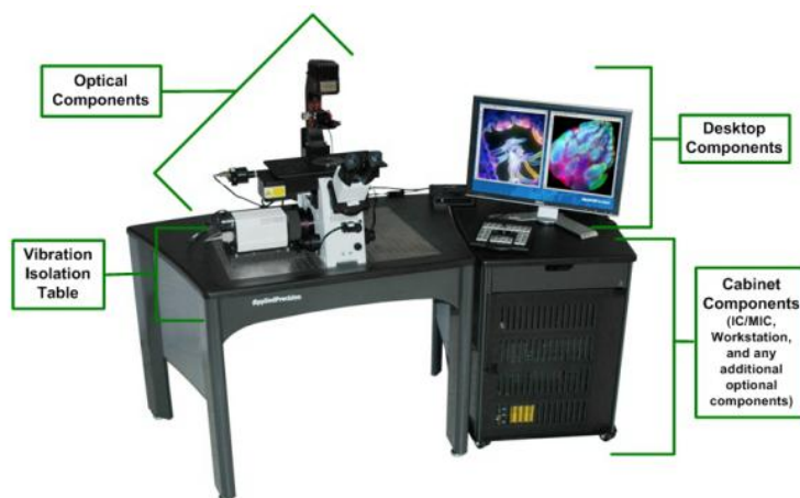
Figura 17: DeltaVision Workstation , ambiente di lavoro del microscopio a fluorescenza utilizzato
