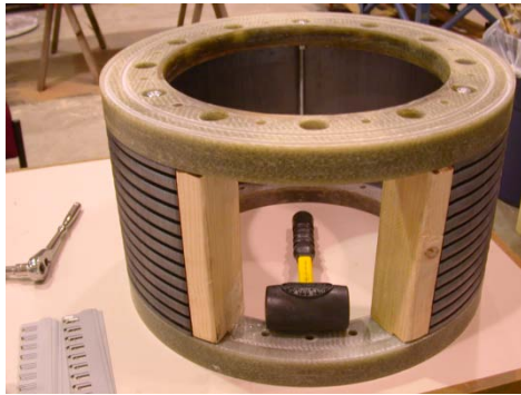
Figura 5.4: Laminazioni radiali di armatura.
