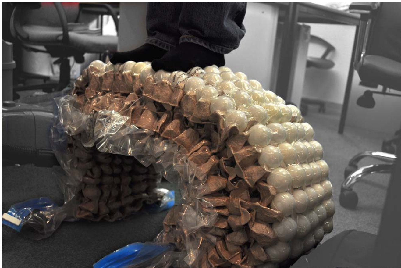
54 Prova di resistenza di un elemento depressostatico strutturale autoapprontato
