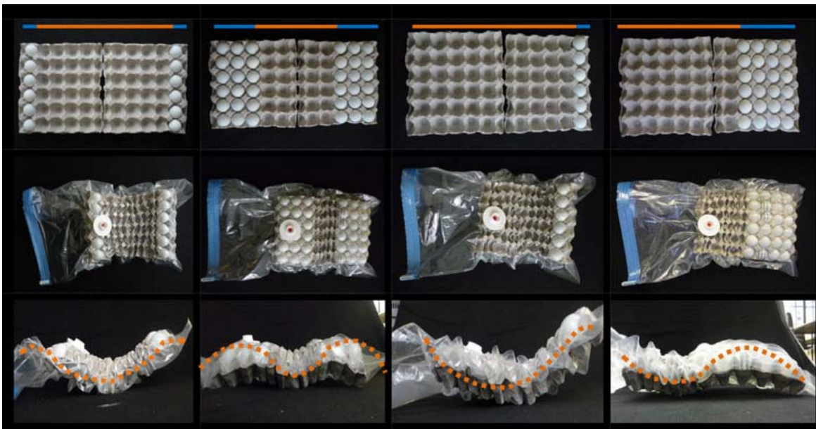
52 Variazioni di curvatura in relazione alla variazione della distribuzione dei pieni e dei vuoti
