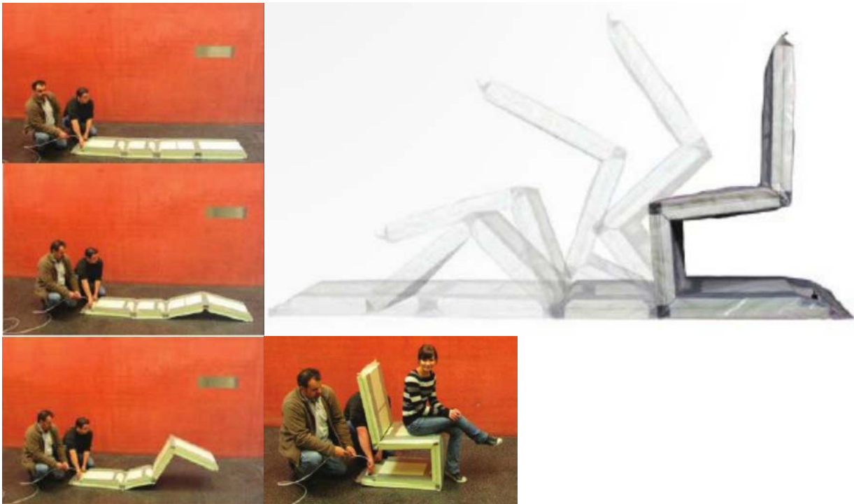
51 Autoappontabilità di un manufatto depressostatico a pannelli
