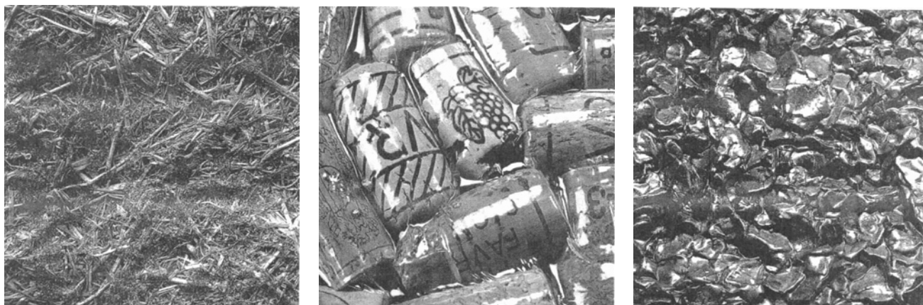
32 Manufatto depressostatico di tamponamento abbinato a materiale isolante: paglia, tappi di sughero, vermiculite (ILEK, 2005) Fonte: Detail 10/2007 “Materiali traslucidi”, articolo “Vacuumatics – Deflated forms of construction”
