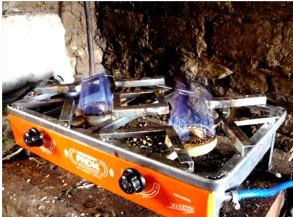
Figura 4.52 Fornello industriale con diffusore verticale installato nella "Granja Alfacancha" a Vilcabamba.
