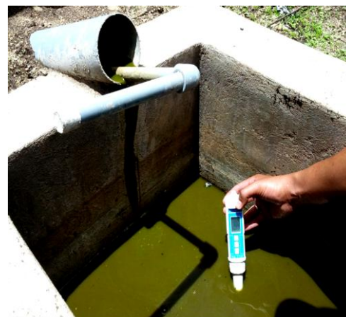
Figura 3.45 Misura del pH del digestato liquido nel pozzetto di scarico.
