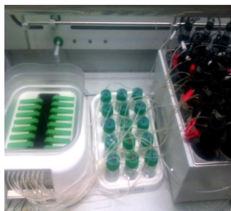
Figura 3.53 Alloggiamento dei reattori in acqua calda (dx), contenitori di soda (al centro), campanelle (sx).
