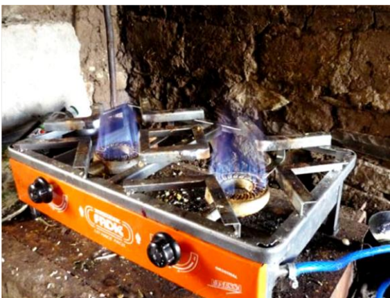
Figura 3.38 Bruciatori adattati al funzionamento con biogas.
