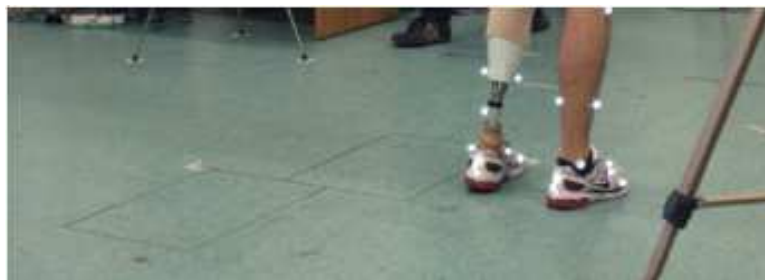
Figura 2.2: Calibrazione statica: posizione a gambe unite a fianco della pedana.
