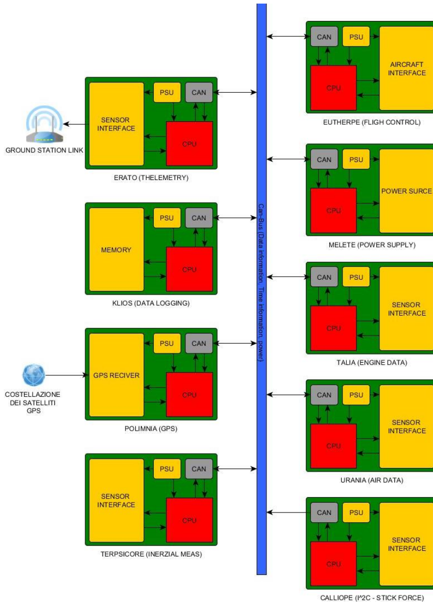
Figura 2.1 - Architettura del sistema FTI Mnemosine MK3
