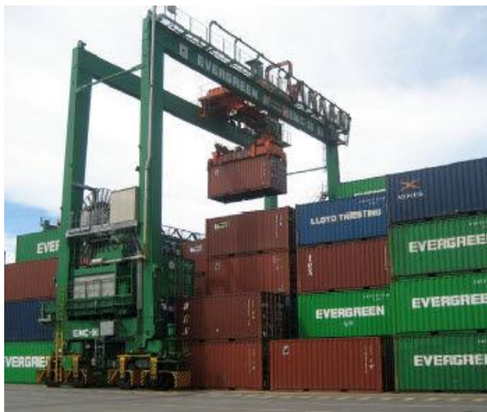
Figura 53: Gru di piazzale su gomma
