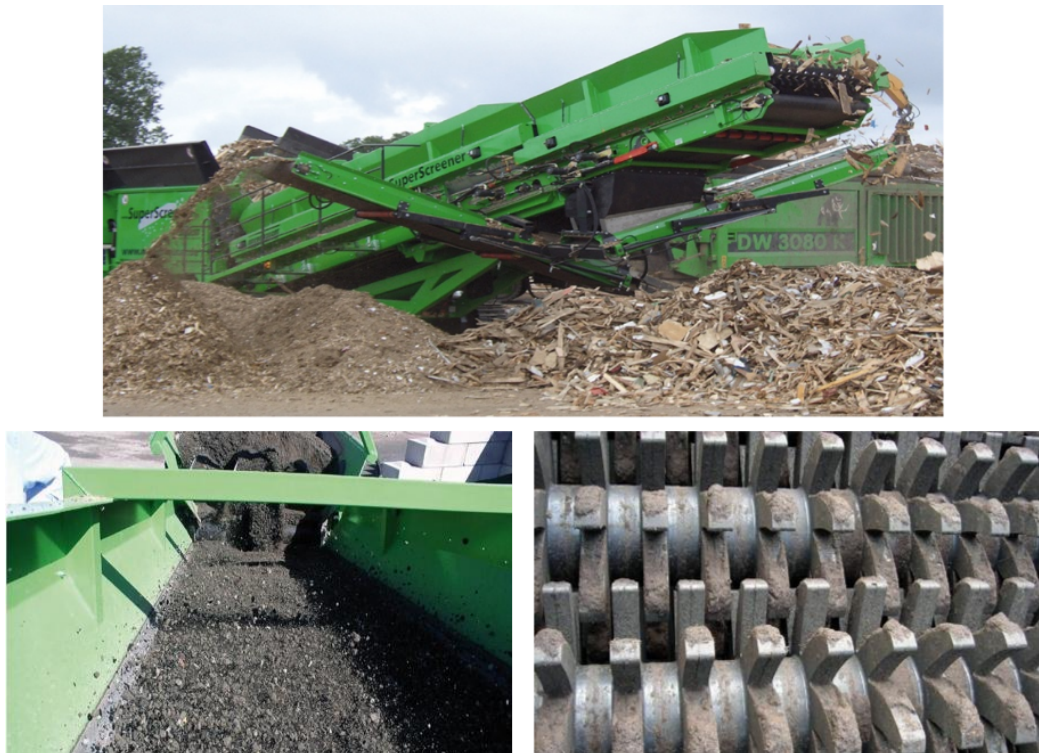
Figura 2.7: Esempio di vaglio Stellare (Neuenhauser)
