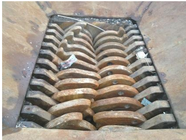
Figura 2.10: Esempio di lacerasacchi (Shearmaster)
