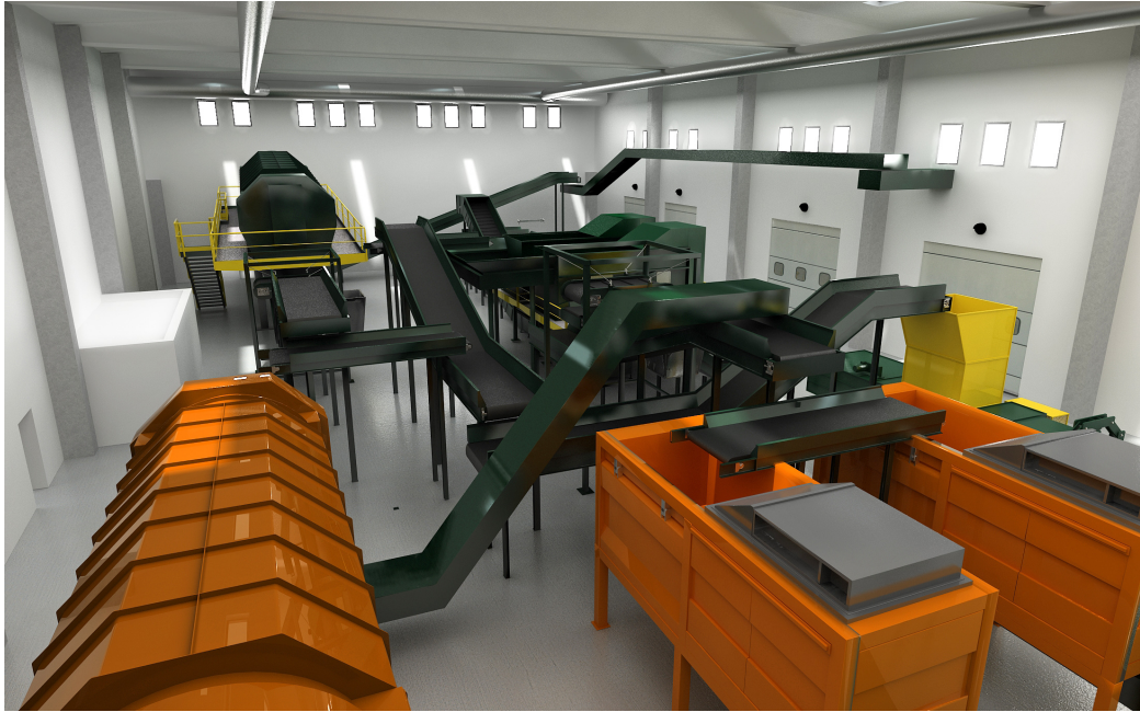
Figura 2.13: Vista interna di un ipotetico impianto MBT.
