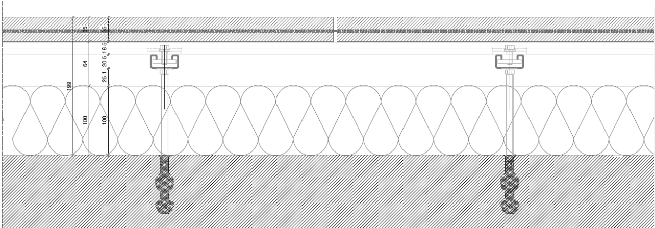
Figura 3.19 Stratigrafia sezione orizzontale lastre Mariotti
