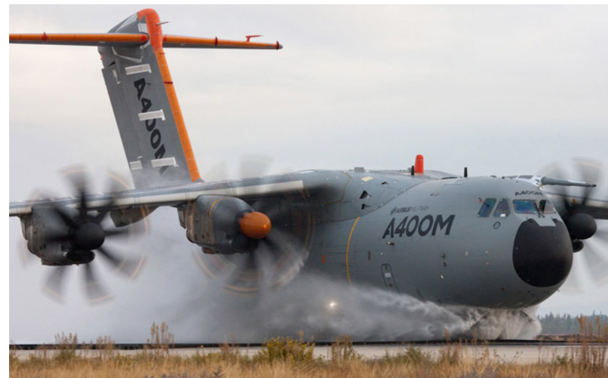
Immagine 48. EADS/Airbus Military 400M Atlas Prova d'atterraggio su superfici bagnate usando gli inversori di spinta, il 1 mo Novembre 2011.
