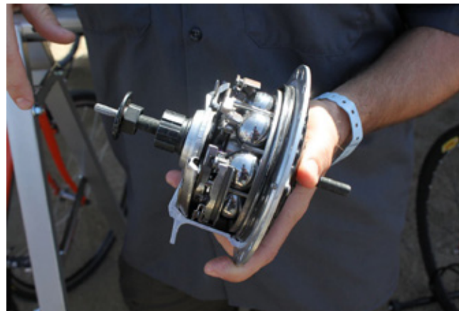
Immagine 37. Taglio in sezione di un mozzo NuVinci.
