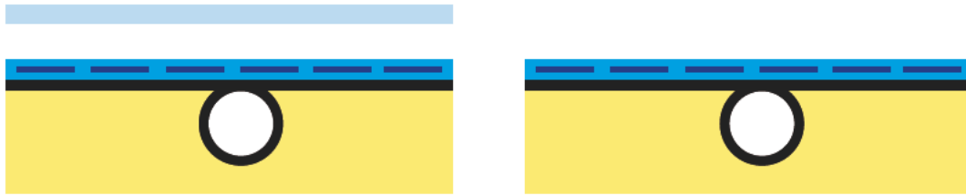
Figura 3.2 – Schema di collettore covered e uncovered
