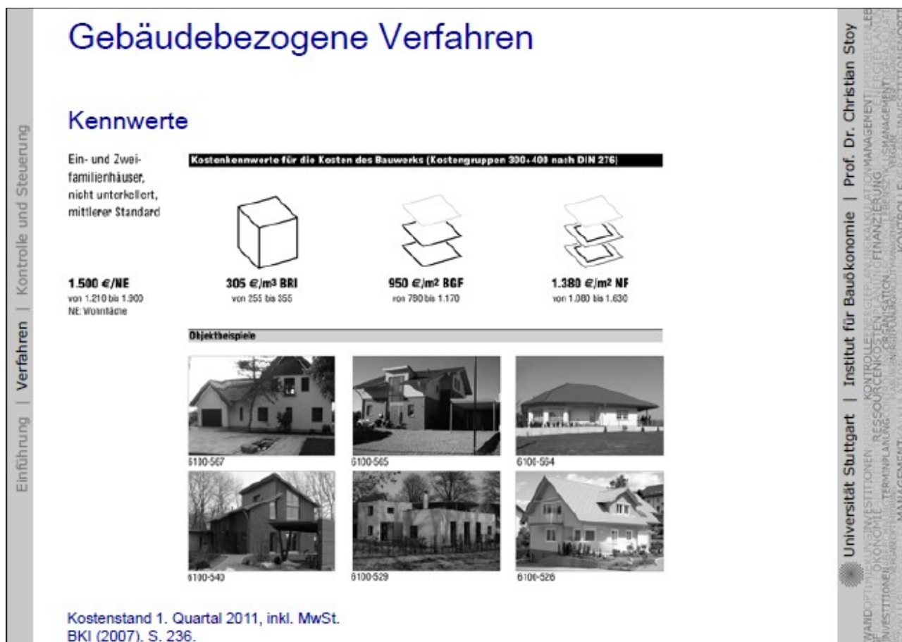
Fig. 2.237 - Unità di misura di riferimento per la determinazione dei costi a seconda della tipologia di immobile (Stoy C., 2012)
