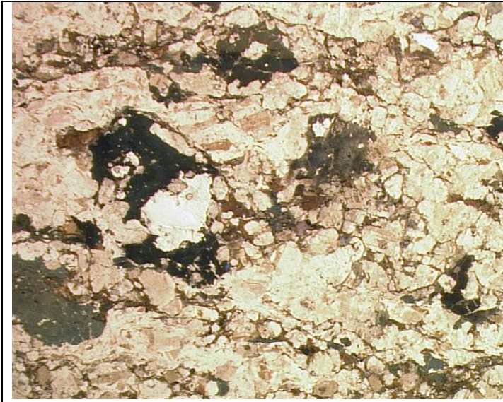
Fig. 4.4: sezione sottile GBI48, progressiva 11+735 km, tonalite milonizzata. Immagine a nicols paralleli.
