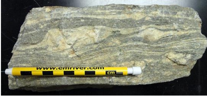
Fig. 1.6: Campione di milonite: forte deformazione della roccia [AGU, American Geophysical Union]
