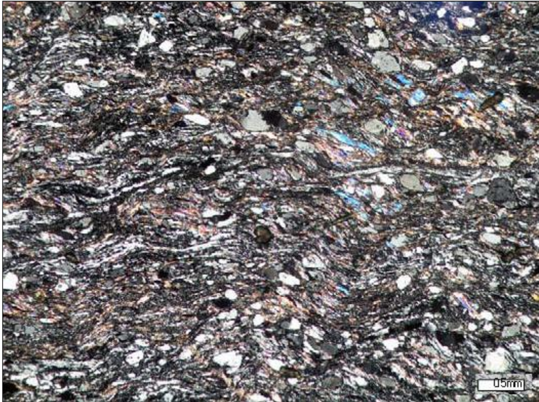
Fig. 4.11: ingrandimento sezione sottile GBI54, progressiva 11+791 km. Immagine a nicols incrociati. Scisto a muscovite, opachi e carbonato di calcio secondario nelle fratture.
