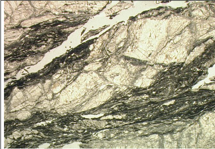
Fig. 4.13: sezione sottile, cataclasite, progressiva 11+821 km. Immagine a nicols paralleli.
