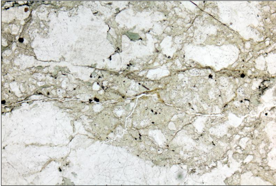
Fig. 1.3: Cataclasite granitica: cristalli frammentati e angolosi. Immagine a N//, 2x (lato lungo = 7mm) [Portale di petrografia on-line, A. Da Mommio website]
