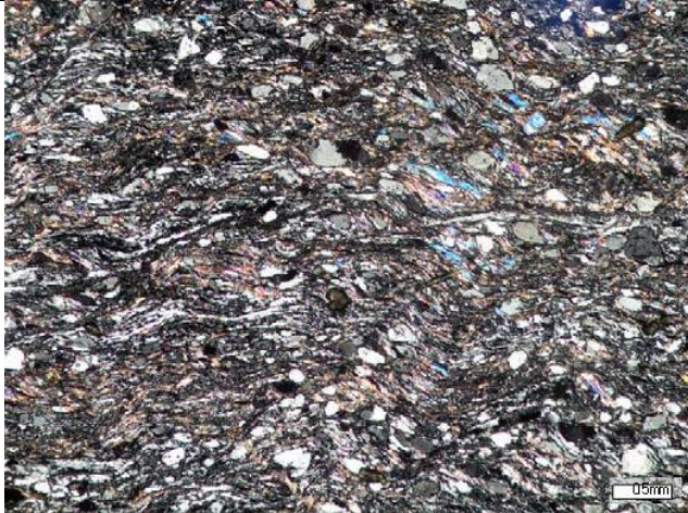
Fig. 4.16: sezione sottile GBI54, scisto filladico, progressiva 11+791 km. Immagine a nicols incrociati. Evidenze di carbonato di calcio secondario.
