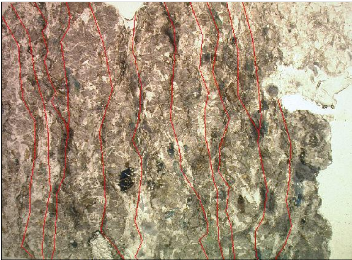
Fig. 4.18: sezione sottile GBI44, progressiva 11+575 km. Sistemi di microfratture.
