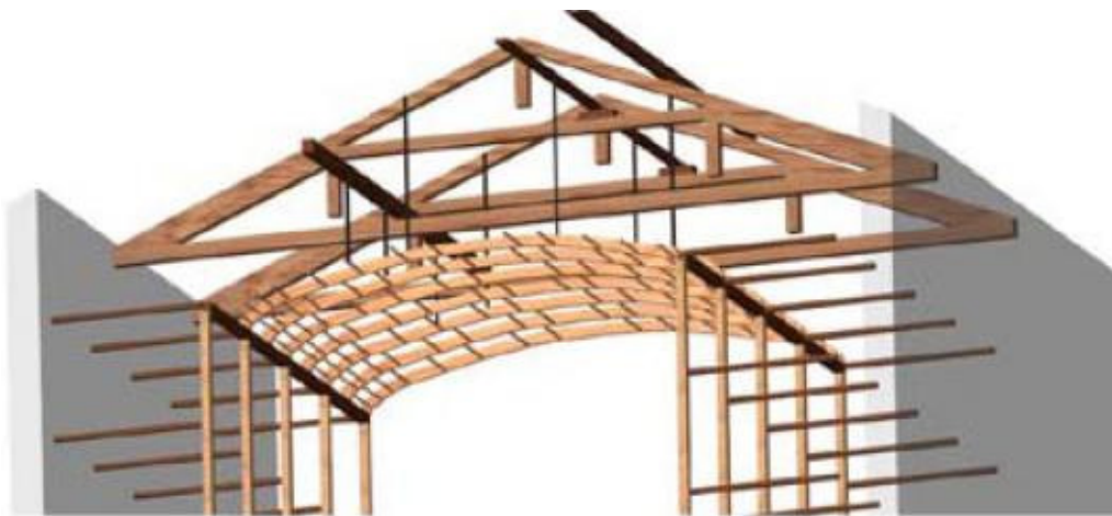
Figura 36 - Schema delle armature di copertura e delle intelaiature lignee della sala
