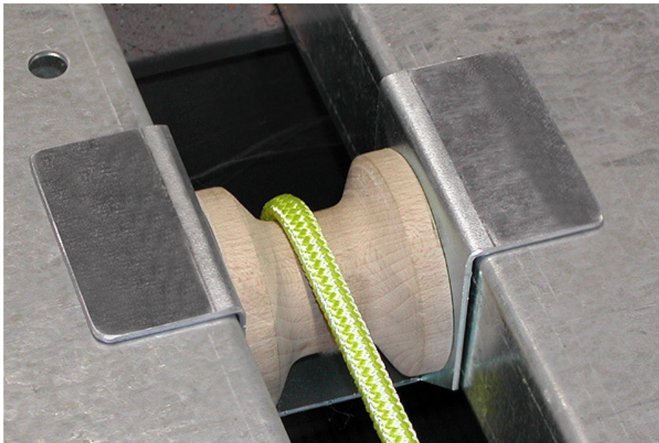
Figura 112 - Particolare del ronchetto in legno incastrato su doghe in acciaio
