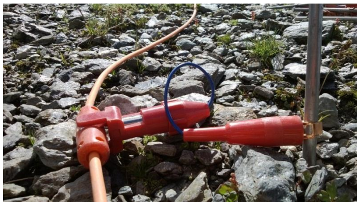
Figura 2.29. Elettrodi e picchetti utilizzati per le indagini elettriche del Luglio 2013.
