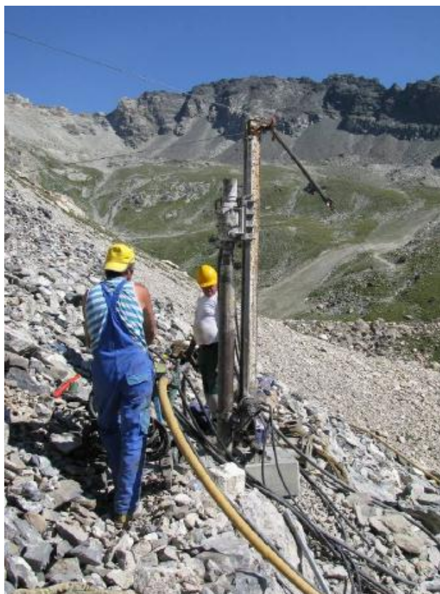
Figura 1.17. Perforazione ad alta quota per lo studio del permafrost. L'unico sistema per poter studiare direttamente il permafrost è quello di effettuare delle perforazioni profonde, altrimenti il suo studio è basato su dei metodi indiretti.
