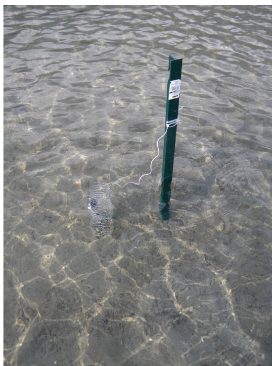
Figura 3.17 – Gabbia in rete metallica con i Diver
