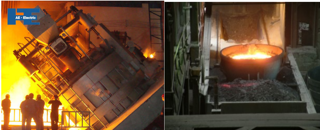
Figura 1.8 a) Foto di un forno elettrico durante le operazioni di scorifica. b) Foto di una paiola colma di scoria fusa.
