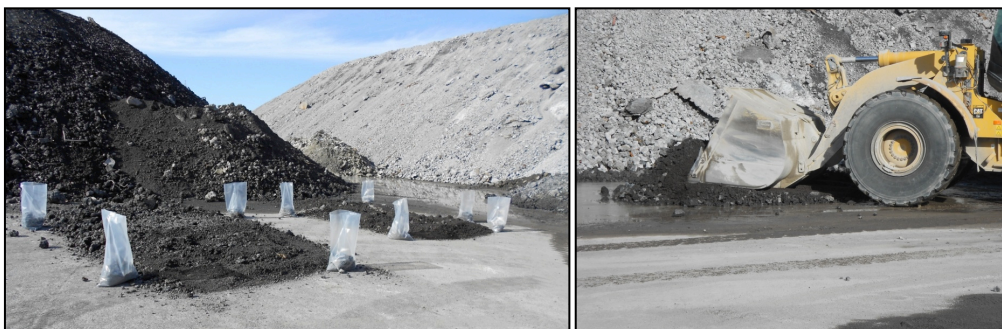
Figura 3.2 a) Foto del campionamento della scoria b) mezzo meccanico durante le operazioni di movimentazione.
