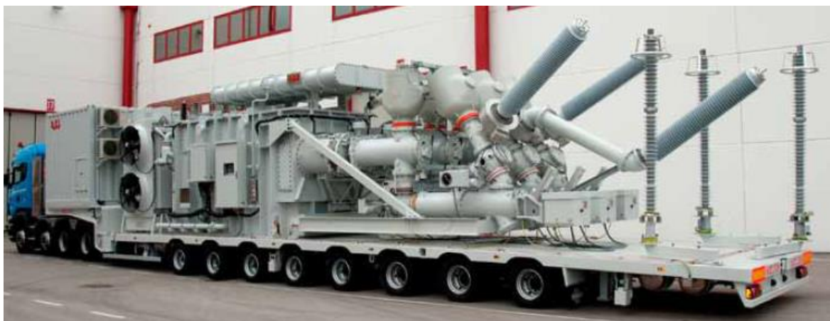
Figura 6-3: modulo MFM a 220 kV pronto per il trasporto
