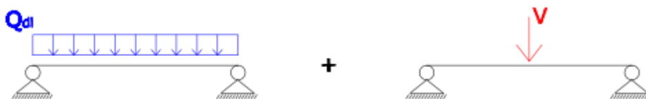
Figura 165. Schema statico della trave principale. Fonte: elaborazione grafica dell'autore.
