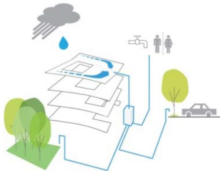
Figura 184. Schema del recupero delle acque meteoriche. Fonte: www.temporaryin.com .
