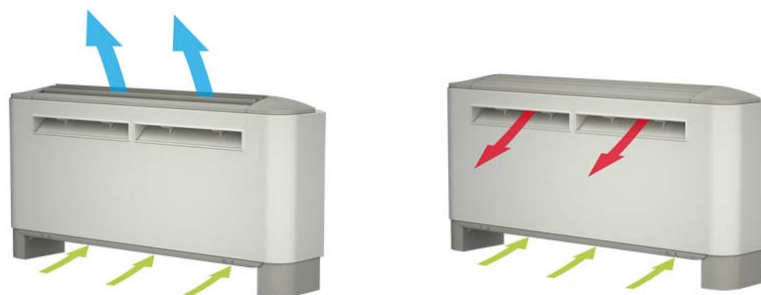
Figura 176. Schema funzionamento dei ventilconvettori. Fonte: www.aermec.com
