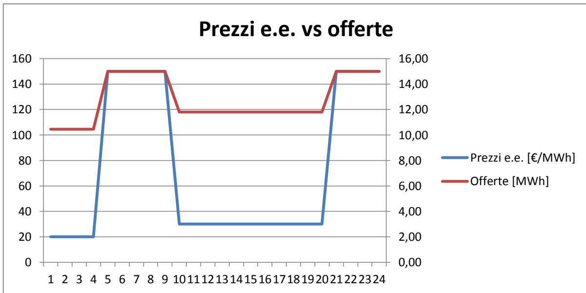
Fig. 3.2-8: Prezzi energia elettrica vs offerte per ogni ora nel test 3 (caso serbatoio con E_{max} 40 MWh e PhM di 10 MW)
