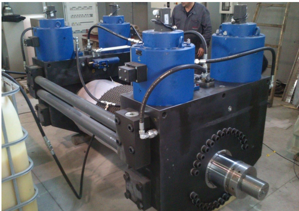
Figura 5.9: Attuatore orizzontale in fase di collaudo
