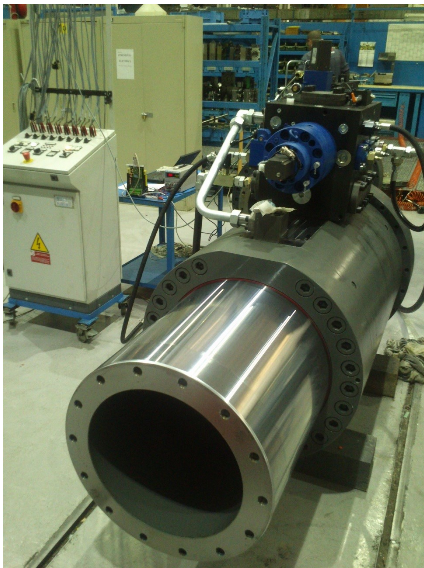
Figura 5.18: Attuatore verticale in fase di collaudo
