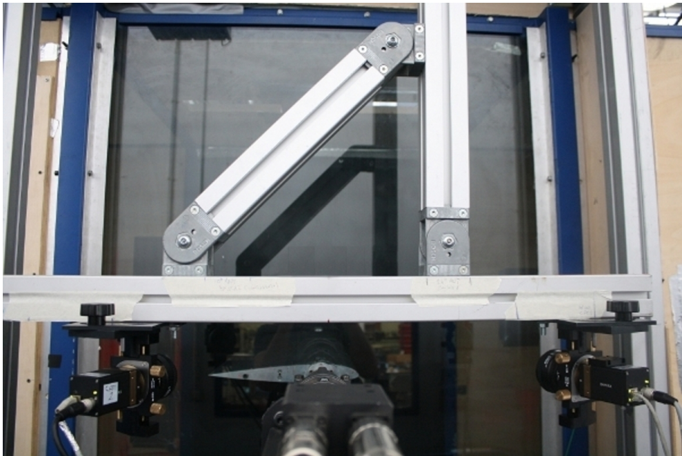
Figura 3.12: Braccio di supporto delle telecamere
