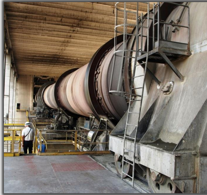
Figura 42 - Forno a tamburo rotante della cementeria Buzzi Unicem (Robilante, CN).
