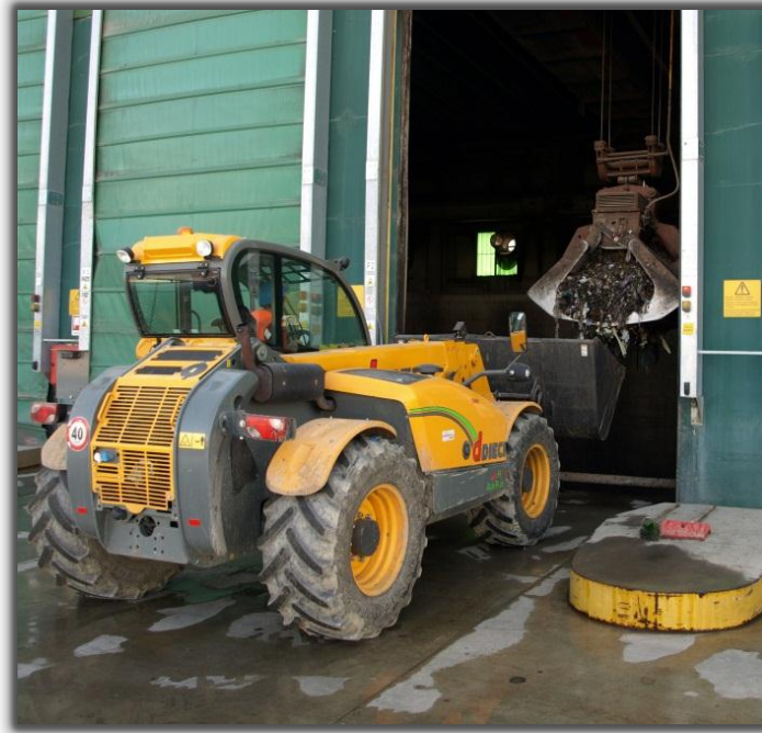
Figura 52 - Estrazione di un campione di RUR pre-triturato dalla vasca di pre carico.
