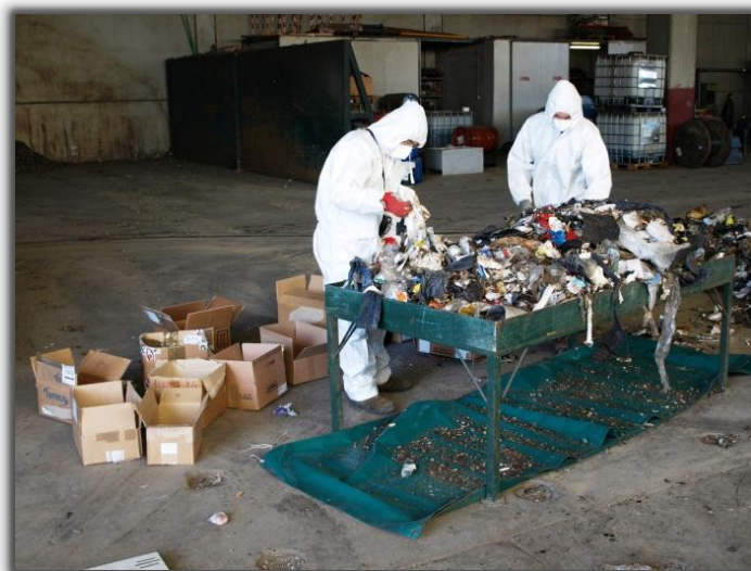
Figura 54 - Cernita manuale di un campione di RUR, eseguita su di un vaglio con fori di 20 mm.
