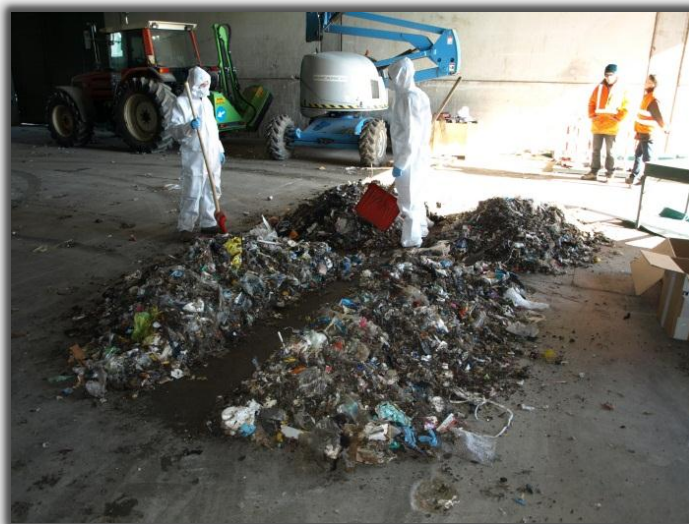
Figura 53 - Fase di quartatura di un campione di RUR.
