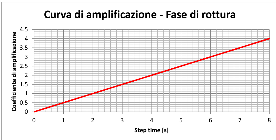
Figura 5.24: curva di amplificazione dei cedimenti vincolari. Il suo valore massimo è 4 (come il massimo spostamento imposto) ma, per le analisi su alcuni modelli (in particolare per quelli più lunghi), si è arrivati fino a 5, con un aumento dello step time
