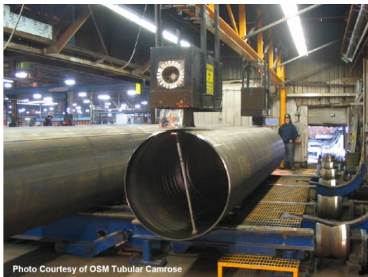
Figura 2.6: ispezione radiografica. Fonte: API 5L, ISO 3183:2007 (Modified) Steel Pipe for Pipeline Transportation System, photo courtesy of OSM Tubular Camrose
