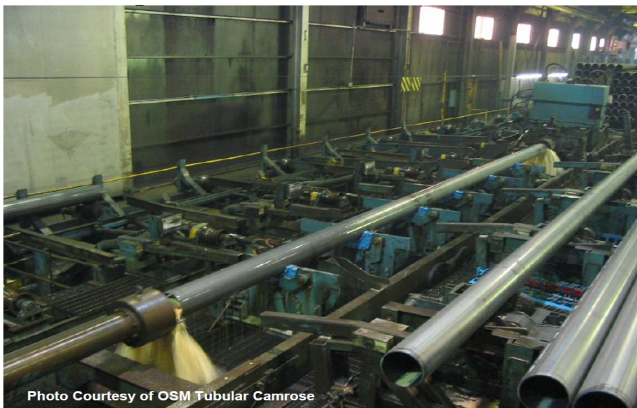
Figura 2.8: hydrotesting su condotta in acciaio con saldature elettriche EW. Fonte: API 5L, ISO 3183:2007 (Modified) Steel Pipe for Pipeline Transportation System, photo courtesy of OSM Tubular Camrose
