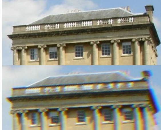
Figura 4.8: Esempio di una fotografia priva di aberrazione cromatica (in alto) e affetta da aberrazione cromatica (in basso).
