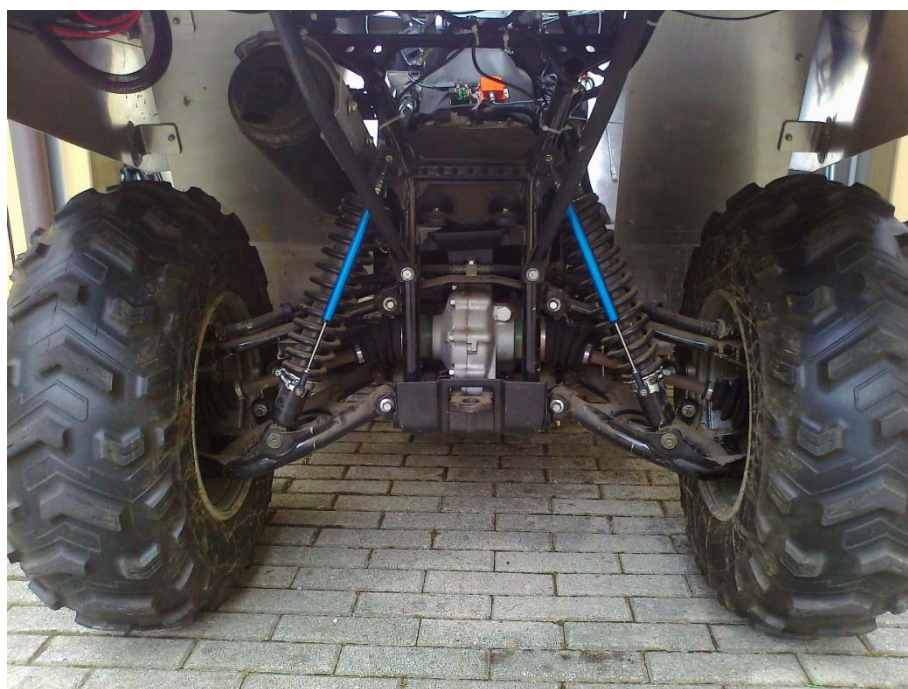
Figura 3.9: Sospensioni posteriori del quad
