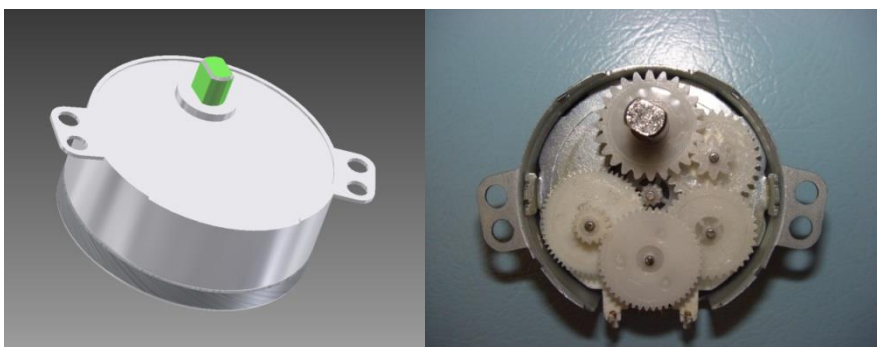
FIG.5.2 Motore a magneti permanenti, sorgente di moto del sistema di trasmissione (disegno CAD e vista interna)
