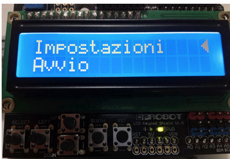
Fig. 33: Immagine illustrativa del menu principale: tramite i tasti “su” e “giù” è possibile muoversi all’interno del menù e selezionare tramite il tasto “select” la specifica voce
