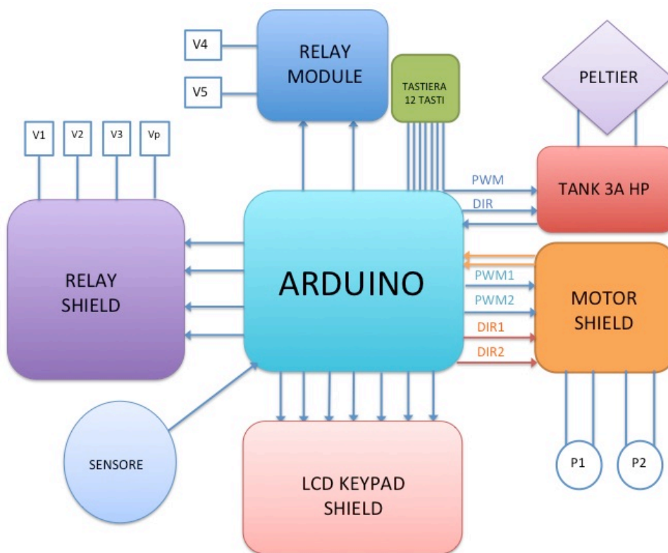
Fig.32: Schema dell'hardware in cui vengono mostrati i vari collegamenti e il numero di connessioni coinvolte
