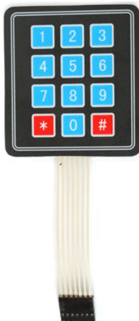
Fig.30: Tastierino a 12 tasti con connettore a 7 pin per l'interfaccia con Arduino
