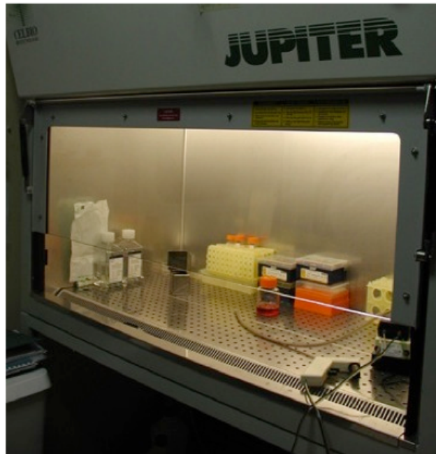
Fig.3: Cappa a flusso laminare
