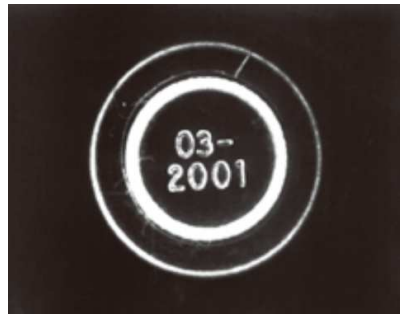
Figura 6. Acquisizione con sistema d'illuminazione Low Angle .
