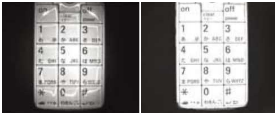
Figura 4. Acquisizioni con illuminazione diretta e con sistema Dome .
