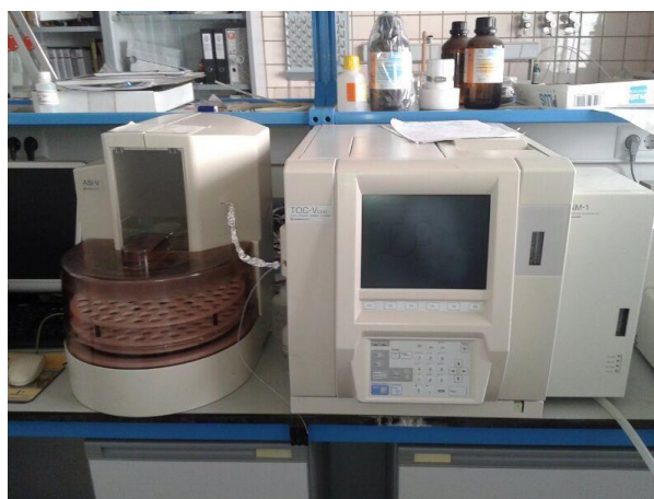
Figura 29. Apparecchiatura per la misurazione del carbonio organico totale (TOC)
