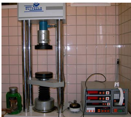
Figura 24. Apparecchiatura per la misurazione della resistenza a compressione
