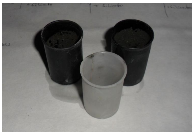
Figura 21. Contenitori cilindrici in plastica in cui viene posta la pasta geopolimerica
