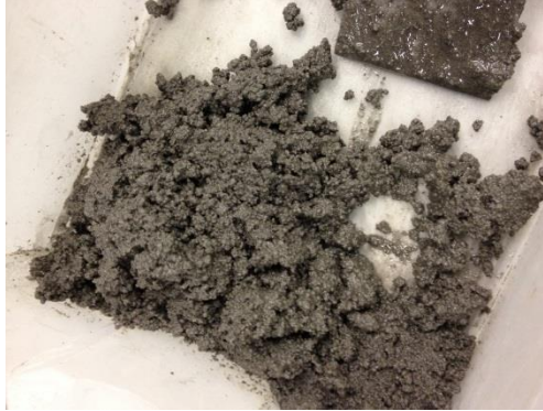
Figura 32. Pasta geopolimerica che non assumeva la consistenza tixotropica richiesta
