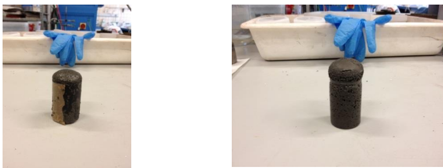
Figura 39-40. Geopolimeri creati con una quantità maggiore di soluzione di NaSil-NaOH
