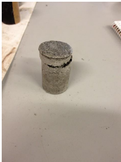
Figura 23. Geopolimero estratto dalla provetta e sottoposto a prova di resistenza a compressione
