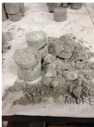
Figura 33. Geopolimeri dalla bassa resistenza a compressione
