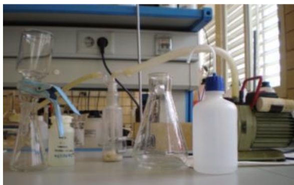
Figura 27. Apparecchiatura per la filtrazione sotto vuoto
