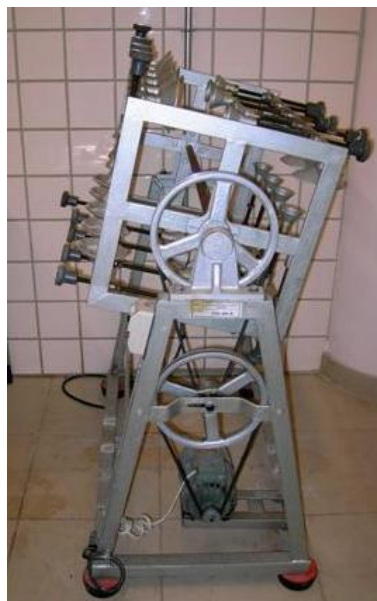
Figura 26. Macchinario per far roteare la miscela composta da geopolimeri solidi e acqua pura
