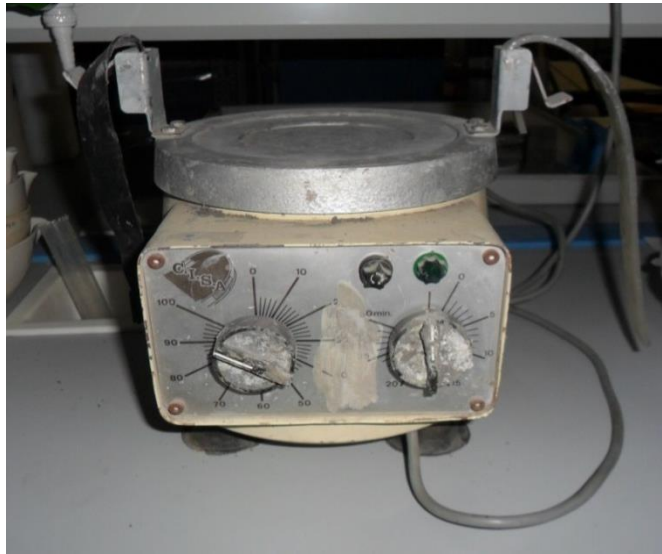
Figura 22. Macchinario vibrante utilizzato per il riempimento delle provette
