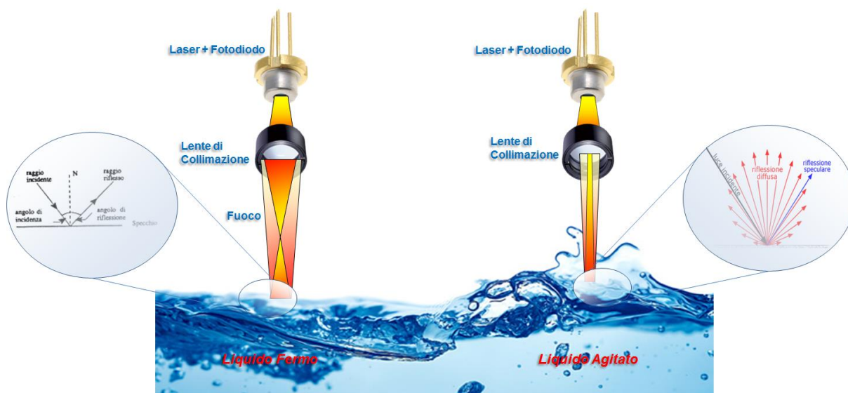
Figura 3.4 Configurazioni ottiche: fuoco prima del bersaglio (a sinistra) e fuoco dopo il bersaglio (a destra).
