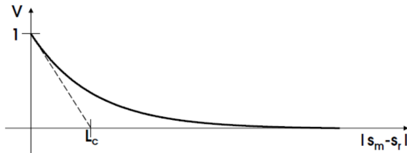
Figura 2.6 Andamento della visibilità V in funzione della differenza di lunghezza dei bracci
