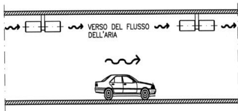
Figura 26: Esempio di sistema di ventilazione longitudinale con ventilatori a induzione
