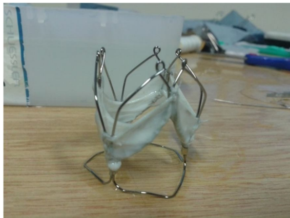
Figura 12: Valvola in pericardio decellularizzato con leaflets e ali
