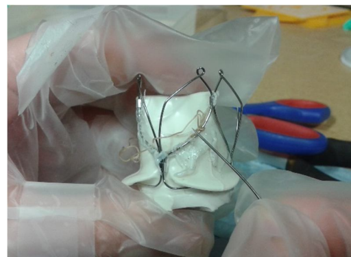
Figura 9: sutura del tessuto allo stent
