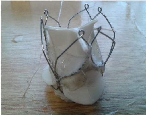
Figura 10: leaflets cuciti allo stent
