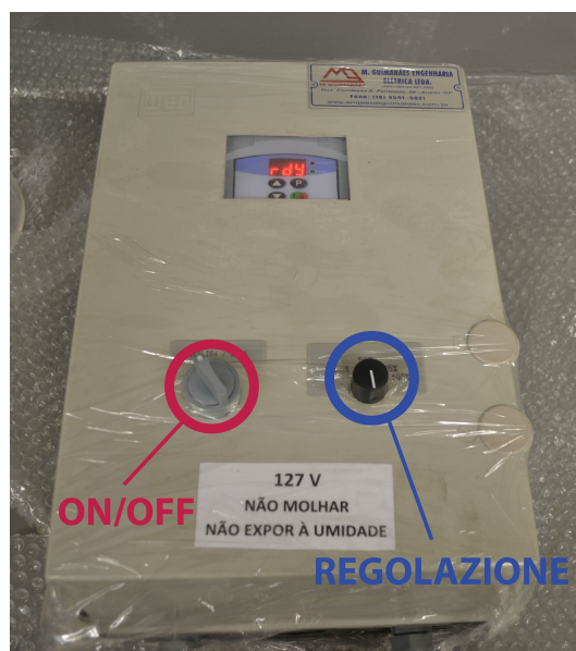
Fig. 4.4. Convertitore di frequenza utilizzato per la regolazione della velocità della ventola.
