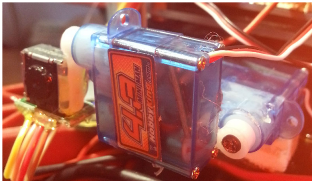
Figura 4.19: La WiiCam montata sui servo
