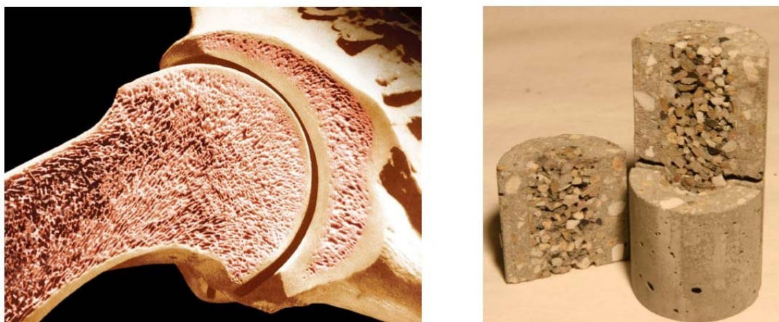
Figura 2.52 Sezione di un osso esternamente compatto e internamente spugnoso (sinistra), sezione di un cilindro in calcestruzzo poroso in analogia con la composizione di un osso tipo (destra). [42]
