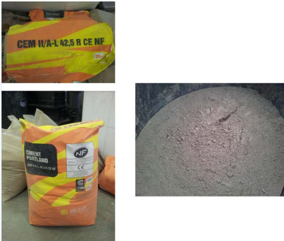
Figura 3.2 Cemento CEM II/A-L 42,5 R. Confezione (a sinistra), aspetto del materiale (a destra).
