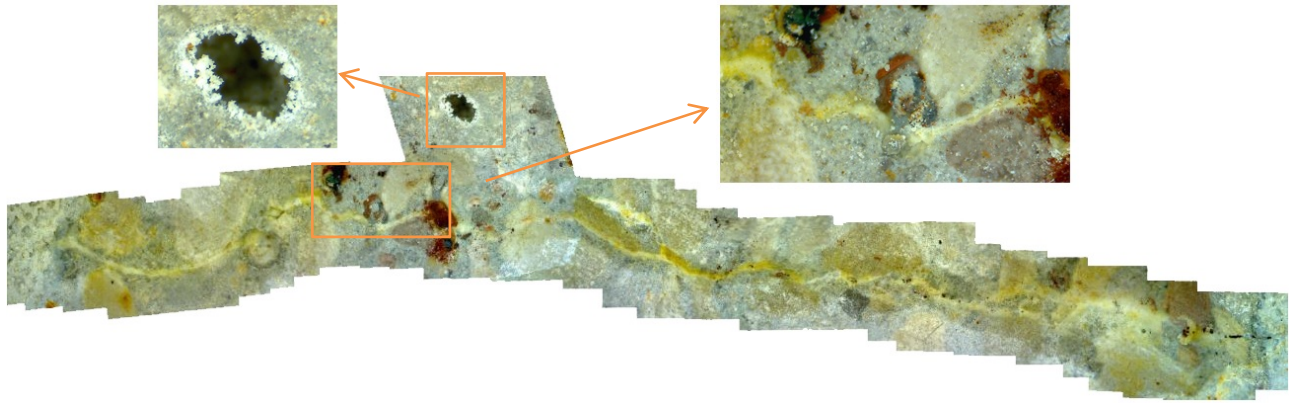
Figura 4.44 Impasto AM4S-4, campione 2A, superficie superiore, fessura costantemente bagnata e strato spesso 2 cm di acqua liquida sulla superficie superiore. Stato della fessura dopo 42 giorni di cura.
