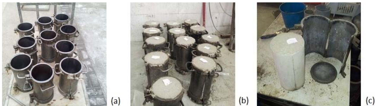
Figura 3.11 Preparazione stampi in acciaio mediante, utilizzo disarmante (a), campioni lasciati a riposo all'interno della forma per 24 ore (b), disarmo dei campioni e sistemazione in camera umida (c).
