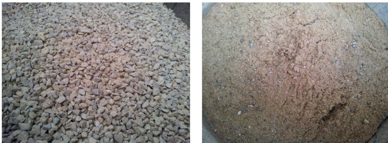
Figura 3.3 Foto esemplificative pietrisco frantumato 7/12 (a sinistra), sabbia (a destra).
