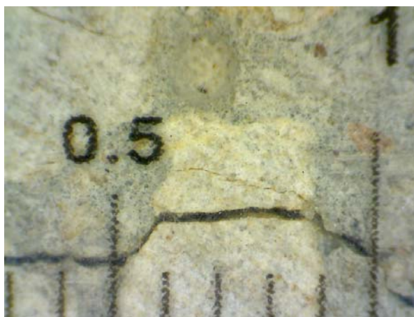
Figura 3.25 Esempio foto di riferimento per la determinazione della relazione tra pixel e millimetri.
