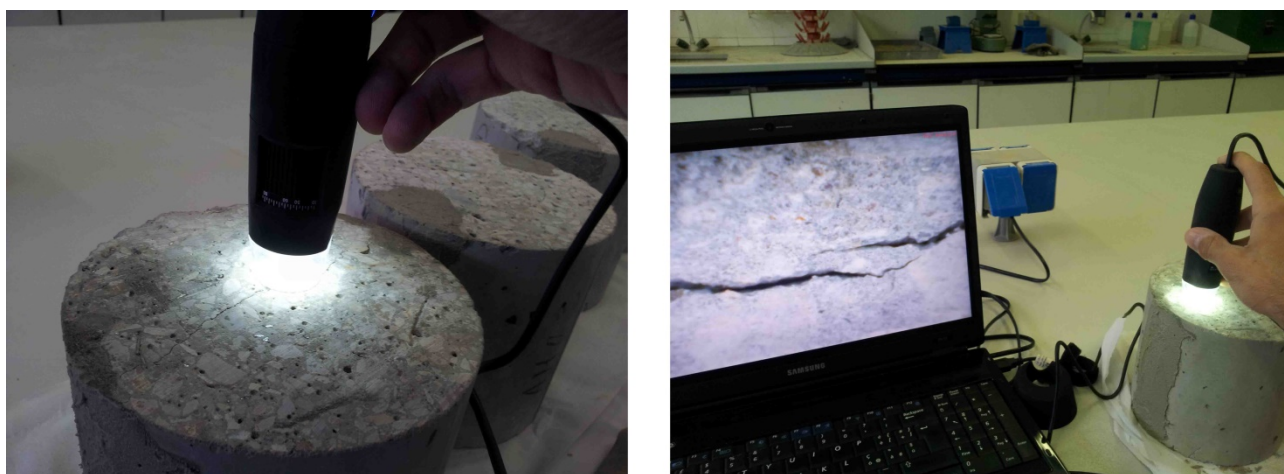
Figura 3.23 Utilizzo microscopio ottico per scattare foto ad alta risoluzione della fessura (sinistra), visualizzazione fessura e elaborazione immagini mediante software.
