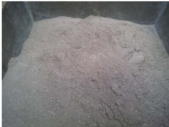
Figura 3.6 Aspetto additivo cristallino al momento della fabbricazione del calcestruzzo.
