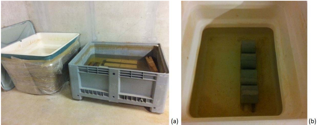
Figura 3.18 Immersione dei campioni con e senza additivo in due diverse vasche (a), stato dei campioni all'interno delle vasche (b).
