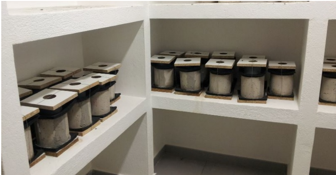
Figura 3.22 Campioni con sistema per il mantenimento della fessura sempre bagnata e di uno strato di 2 cm di acqua sulla superficie superiore immagazzinati all'interno della camera umida a 20°C e 95-100% U.R..
