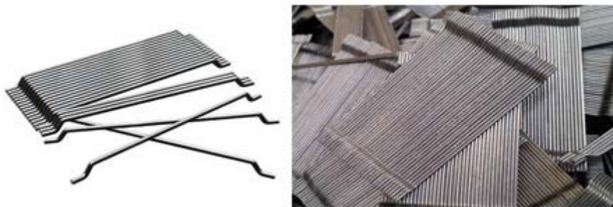
Figura 3.5 Fibre in acciaio, lunghezza 35 mm e diametro 0,55 mm. Immagine presa dal catalogo (a sinistra), aspetto fibre calcestruzzo nelle condizioni di fornitura.
