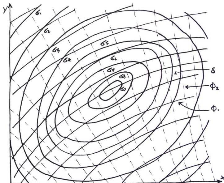
Fig. 14 - Andamento delle curve isostatiche di massimo, minimo e delle isodinamiche di massimo in un solido piano
