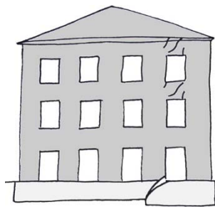
Fig. 41 - Traslazione verticale: cedimento terminale in un muro con aperture
