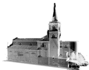
Fig. 78 - Ricostruzione di un edificio di culto attraverso rilievo a laser scanner
