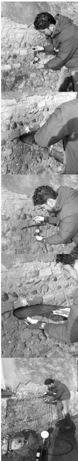
Fig. 154 - Sequenza della prova con martinetti piatti eseguita dall'ing. Bassoli
