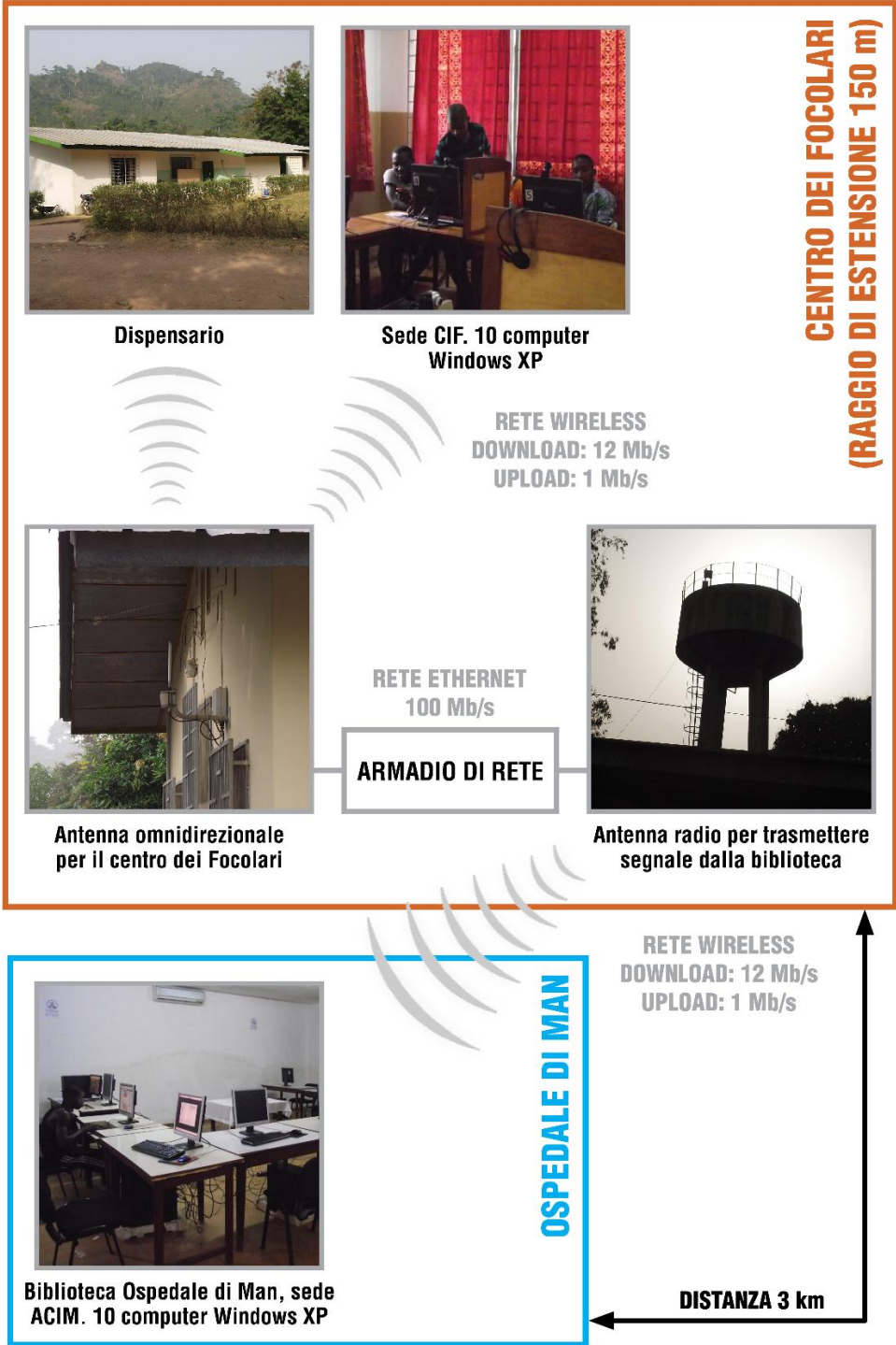
Figura 1.5 Schema delle connessioni nell'ambiente di lavoro.
