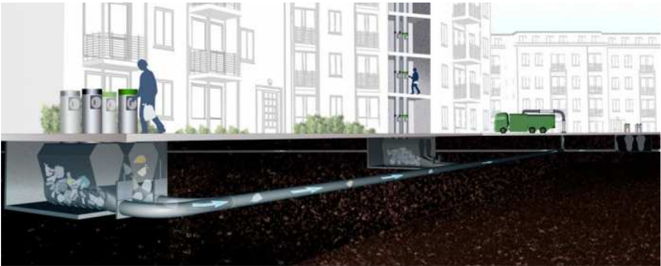
Fig. 3: Sistema di raccolta dell'immondizia pneumatica
