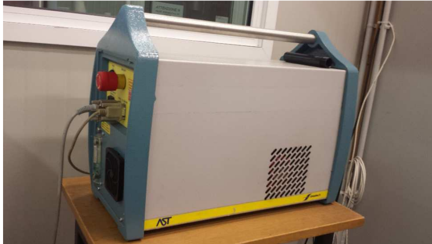
Figura 2.9 Unità centrale X3000 del diffrattometro
