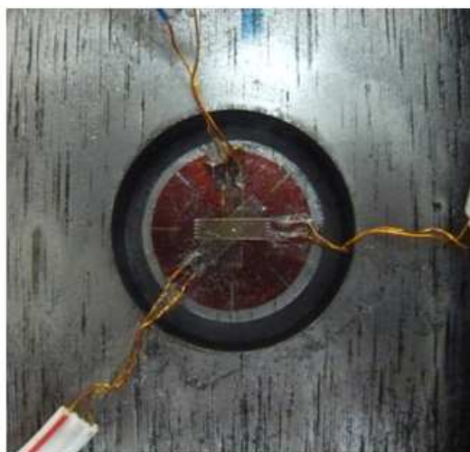
Figura 1.4 Immagine della rosetta estensimetrica dopo l'applicazione della tecnica ring-core
