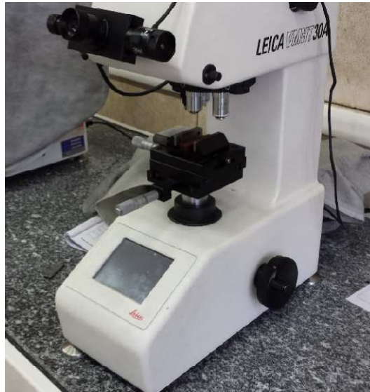
Figura 2.4 Microdurometro utilizzato per le misurazioni sperimentali
