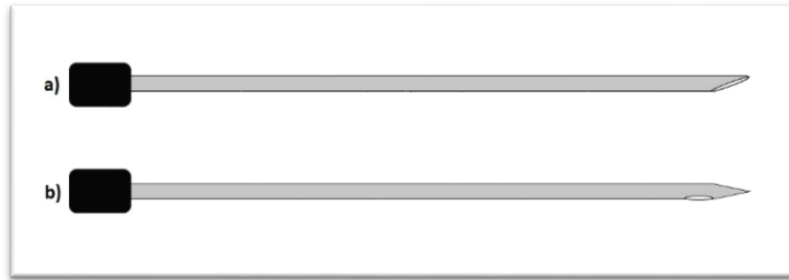
Figura 3.9: gli aghi analizzati durante i test tempo-dipendenti: a) con punta a becco di flauto, b) ago “pencil point”.
