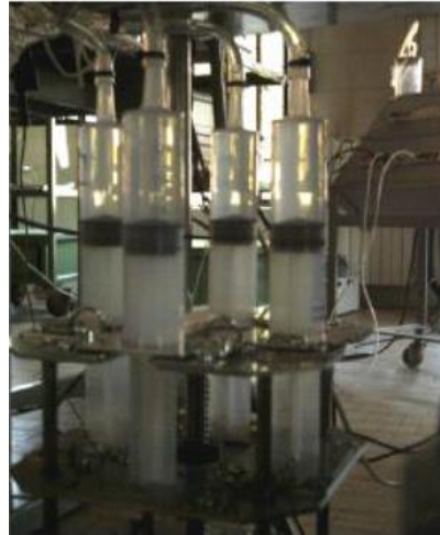
Figura 2.5: particolare del sistema pompante con pompe a pistone (36)
